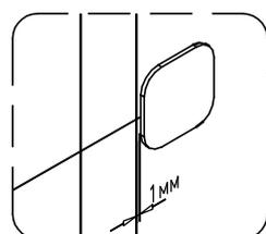
Планку ответную K-Push установите предварительно сняв защитную пленку с клеящего слоя
